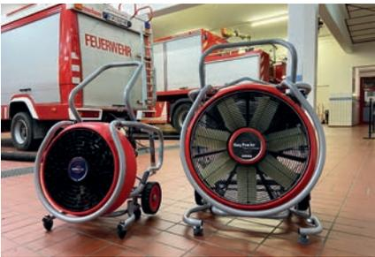
Elektrolüfter (Leader ESV230 Neo EPT) bestens für den Einsatz im Innenraum geeignet und somit ein perfekter Ersatz für den bereits in die Jahre gekommenen alten Lüfter. Für die großen Industriehallen und Tiefgaragen konnte zusätzlich ein Benzinlüfter (Leader MT280 Easy Pow'Air Technologie) mit einer Leistung von 117.100 Kubikmeter pro Stunde im Fahrzeug verbaut werden.
